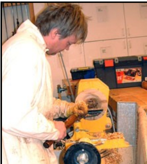
Flansinn skrúfaður á, rennt að utanverðu og sæti fyrir patrónuna. Síðan sett í patrónuna og rennt að innanverðu.
