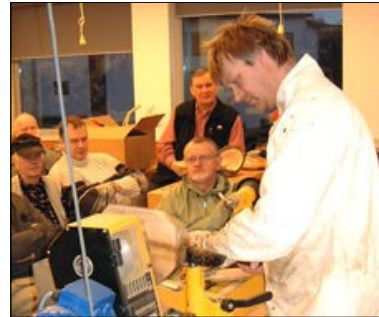
Flansinn skrúfaður á, rennt að utanverðu og sæti fyrir patrónuna. Síðan sett í patrónuna og rennt að innanverðu.
